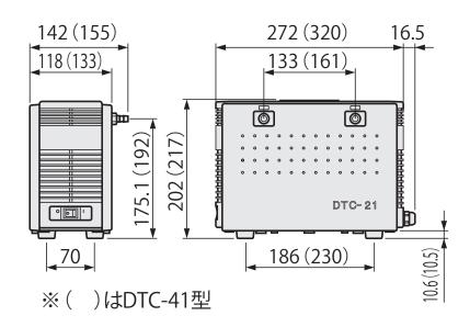
吸気ノズル 外径10×内径6mm(G1/4) 排気ノズル 外径10×内径6mm(G1/4)
