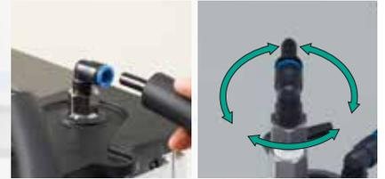
保冷ホースを差込むだけの簡単接続です。工具、バンドは不要です。循環ノズルの向きは360°変えられるので、チューブに掛かる負荷を軽減します。
