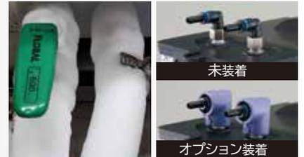
冷却水循環装置の循環ノズル回りの結露・結氷を抑制します。オプションの結露対策カバーを取付けることにより、ロータリーエバポレーターへの循環時、マイナス温度域での使用など、ノズル回りの結露・結氷を抑えます。
